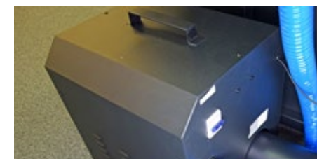
Vysokotlaký vakuový ventilátor s akustickým krytem.
